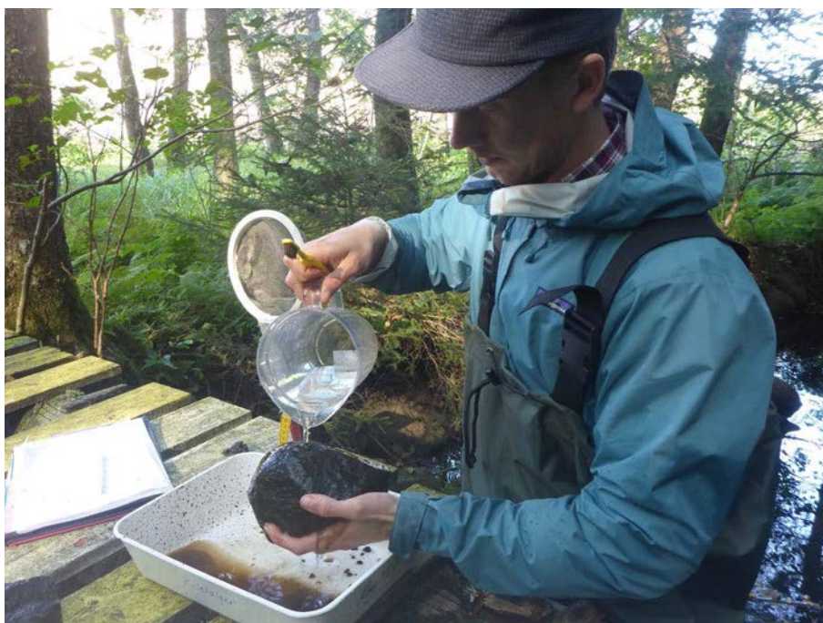
Figur 4. Vid kiselalgsprovtagningen hämtas minst fem slumpvist valda stenar från en representativ sträcka av vattendraget eller litoralen i sjön, varefter kiselalger och övrig påväxt borstas av från stenarna med en ren tandborste (överst). Materialet sköljs av och samlas upp i en vanna (underst). När alla stenar borstats blandas materialet i vinnan nogga och hålls i burkar. Burkarna förvaras svalt och mörkt. Efter att materialet har sedimenterat i burken hålls större delen av vätskan av och ersätts med etanol. Om stenar inte finns på lokalen läggs delar av friska vattenväxter i en burk med åvatten. Burken skakas kraftigt, så att kiselalger och annan påväxt lossnar, varefter vattenväxterna kramas ur och avlägsnas.
