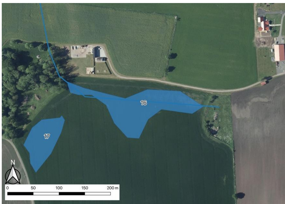
Figur 28. Våtmarken är placerad i en naturlig svacka och kan optimeras för flödesutjämnning av tillkommande dagvatten.
