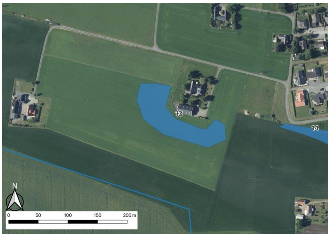
Figur 25. Våtmarksyta med medel hög potential för magasinering och rening av framförallt dagvatten. Tillsammans med åtgärderna 13 och 14 finns hög potential för närreklamation och hög potential som pedagogisk plats för högstadieskolan som ligger i direktanslutning till området.
