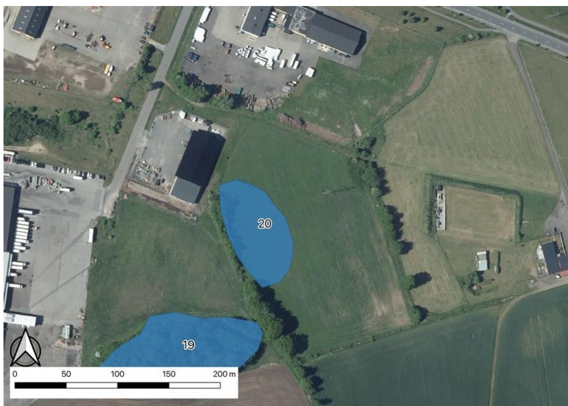
Figur 32. En grund våtmark med fokus på flödesutjämnning.
