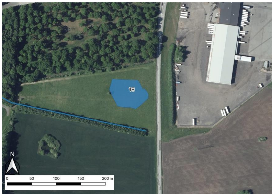
Figur 30. Våtmarksyta med hög potential för magasinering och rening av framförallt dagvatten från västra industriområdet.
