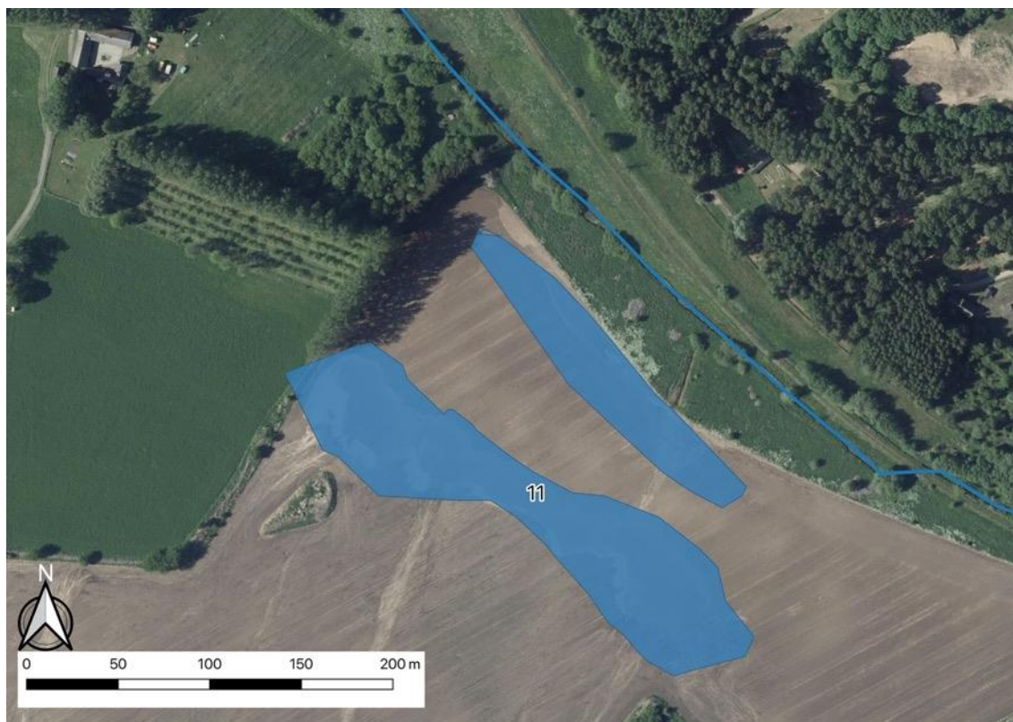
Figur 23. Två alternativa lägen för anläggande av en våtmarksyta som skulle ta emot vatten från ett större jordbruksområde.
