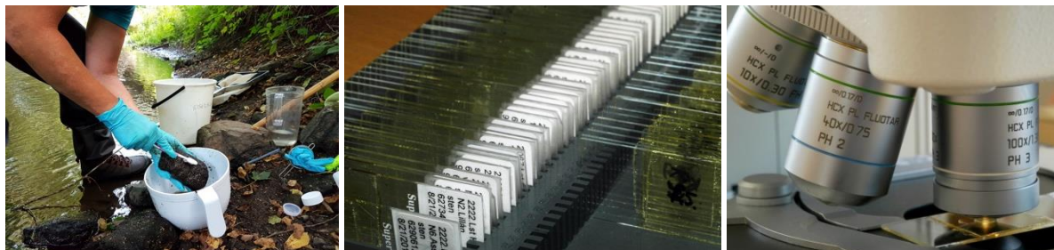
Figur 25. Provtagning av kiselalger görs i första hand genom borstning av stenar varefter proverna prepareras kemiskt och kvarvarande kiselalgsskal fixeras på objektglas till permanenta preparat. Analysen görs i ljusmikroskop i 1000 gångers förstoring. Mikroskopet ska helst vara utrustat med interferenskontrast, vilket gör att man kan se mycket små former tydligare än med andra tekniker.
