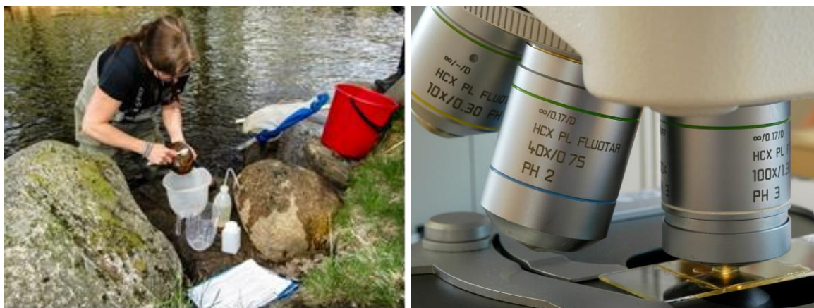
Figur 27. Provtagning av kiselalger görs i första hand genom borstning av stenar varefter kiselalgspreparat framställs och analyseras i ljusmikroskop med 1000 gångers förstoring (objektiv 100x), © Sweco Sverige AB.
